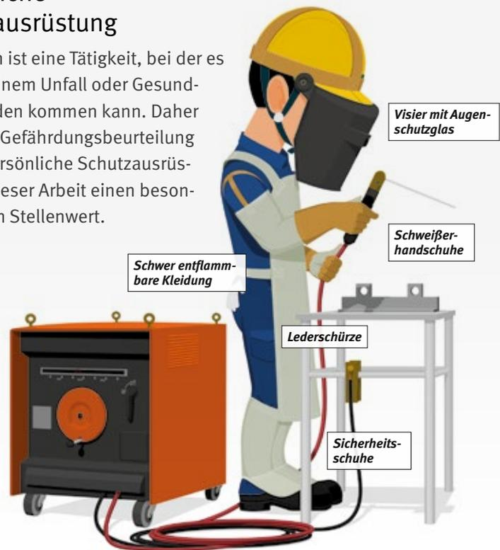
Grundsätzlich muss beim Schweißen schwer entflammbare Kleidung getragen werden, die die Anforderungen der DIN EN ISO 11611 erfüllt und entsprechend zertifiziert ist. Wichtig ist, dass die Kleidung hochgeschlossen getragen wird und nicht mit entzündlichen Stoffen, wie Ölen oder Fetten, verunreinigt ist.
